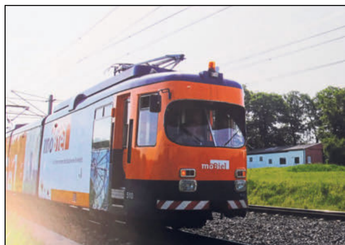
April: Der Schienenschleifwagen von Mobiel steht hier kurz vor der Endstation Bielefeld-Altenhagen. Der Wagen besteht aus zwei 1960 und 1963 gebauten Gelenktriebköpfen und einem Mittelteil mit vier Schleifeinheiten.
